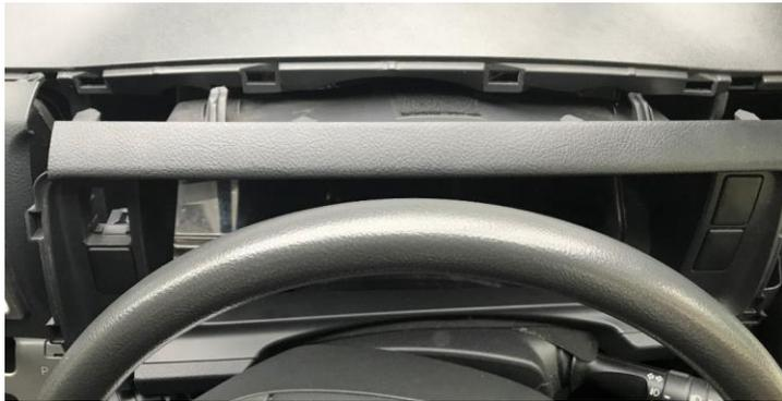
上側四か所の爪をちゃんとすべて入るように確認しながら押し込み、はめた後に下側の爪をすべてはめ込みます。
